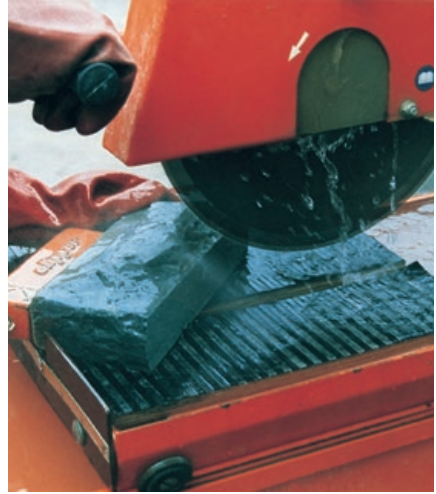
Gehrungsschnitt mit Winkelanschlag
