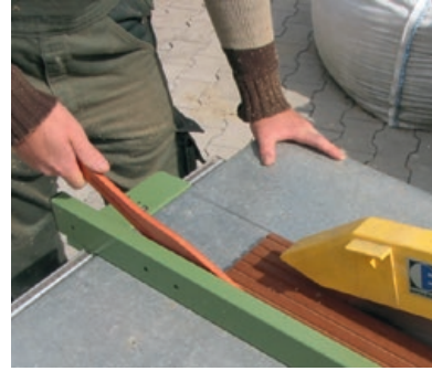
Beim Durchführen schmaler Holzteile Schiebestock nutzen!
