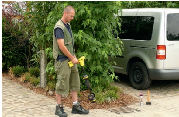
Ortungsgeräte erleichtern das Auffinden von Erdkabeln
