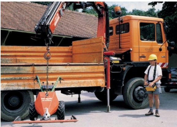
Lkw-Ladekran mit Funkfernsteuerung
