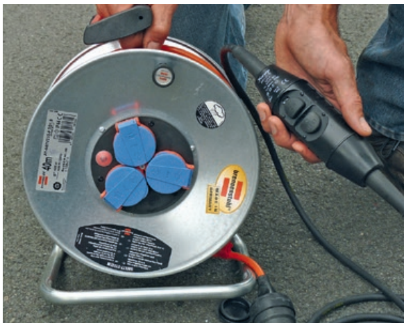
Spritzwassergeschützter Leitungsroller mit selbstschließenden Klappen und Personenschutzschalter; IP Klasse angegeben (z. B. IP 54)
